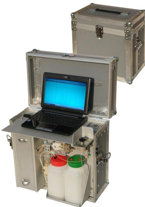
Рисунок 4 - Общий вид хроматографа жидкостного JETchrom портативного.
