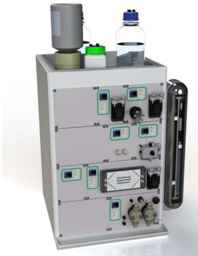
Рисунок 2 - Общий вид хроматографа жидкостного JETchrom лабораторного, моноблочное исполнение.
