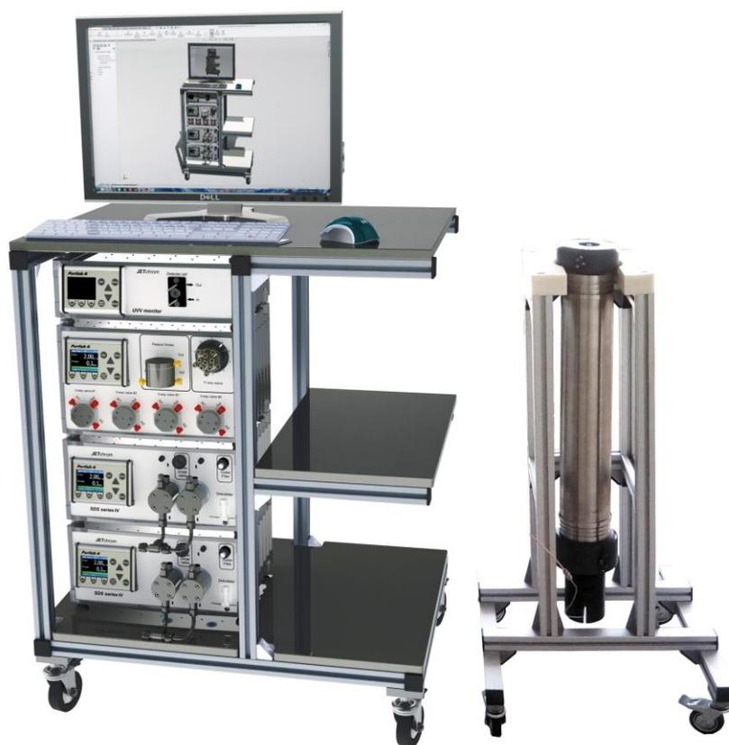
Рисунок 5 - Общий вид хроматографа жидкостного JETchrom препаративного.
