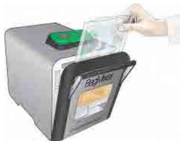
Образец гомогенизируется с разбавителем в лаб. блендере **BagMixer®**. Фильтрация образца происходит в пакете с фильтром при измельчении.
