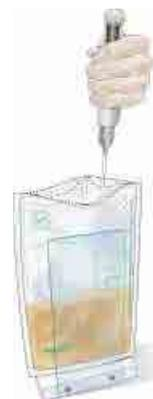
Отберите пробу пипеткой **BagPipet®**. Фильтрация происходит в стерильных условиях и мгновенно. Образец готов для посева и исследования.
