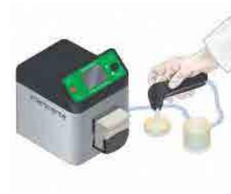
Подготовьте среды с помощью насоса **FlexiPump®** (в пробирках, флаконах и чашках Петри) для оптимального посева.
